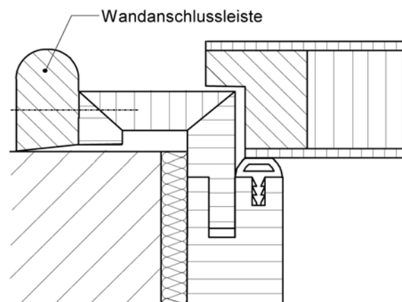
Bild 3 Zargenanschluss mit Zierleiste
