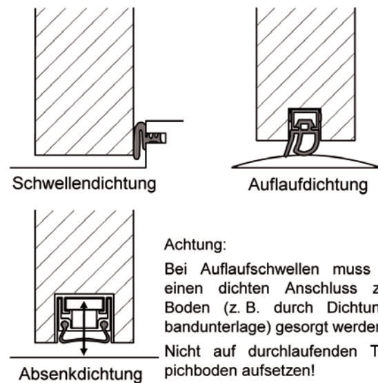
Bild 10 Abdichtungsmöglichkeiten zwischen Tür und Fußboden
